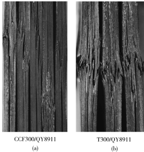
图 5 CCF300/QY8911 与 T300/QY8911 复合材料层合板宏观照片比较
